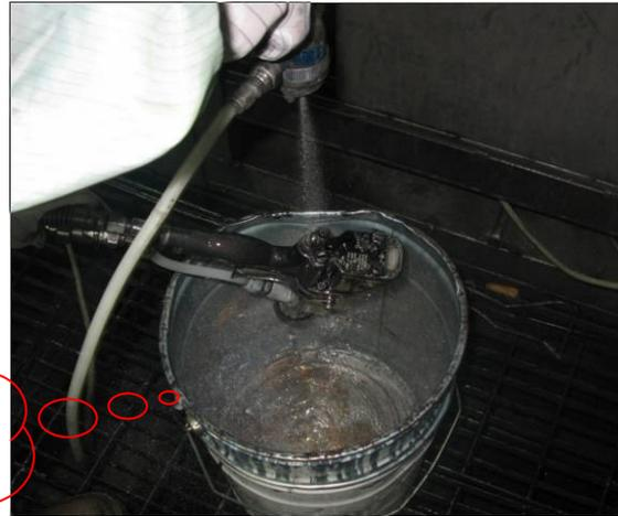
员工清洗喷枪，并将废溶剂回收再利用
