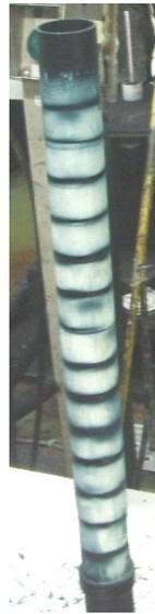
改善后制具采用一个圆管加一底座而成，装取部品简便，喷涂效率大大提高，涂料用量有很大的节省。
