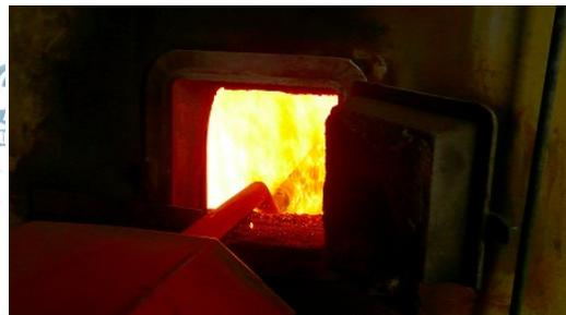
链条锅炉拨火助燃系统的耐高温拨火棒
