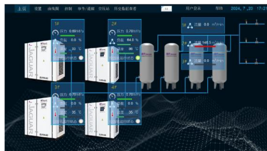
中央空壓系統操作介面
