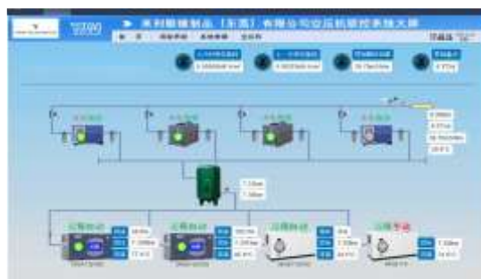
中央空壓系統操作介面
