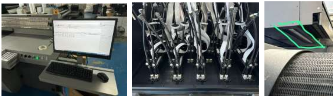
紫外線固化打印機操作平台、打印機噴頭及紫外線燈管
