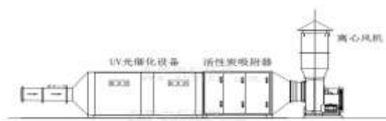
紫外線光解及活性炭吸附設備
