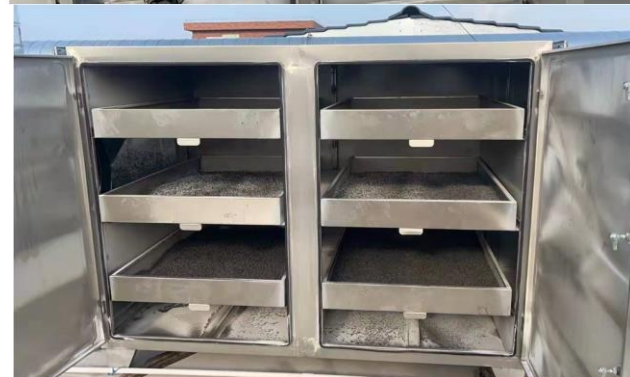
紫外線光解及活性炭吸附設備
