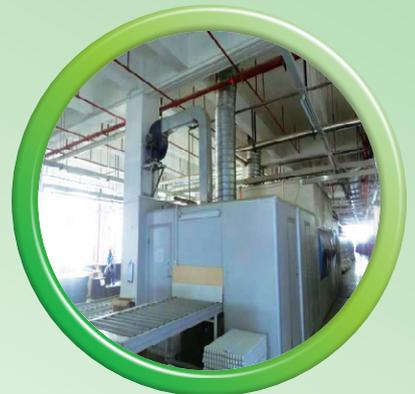
自動紫外線固化噴塗系統
