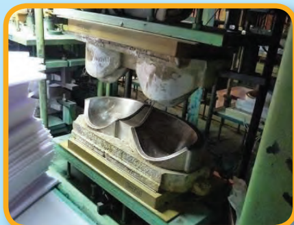
改裝成節能加熱器的壓模機
