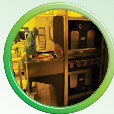
現場的UV-LED線路板曝光系統
