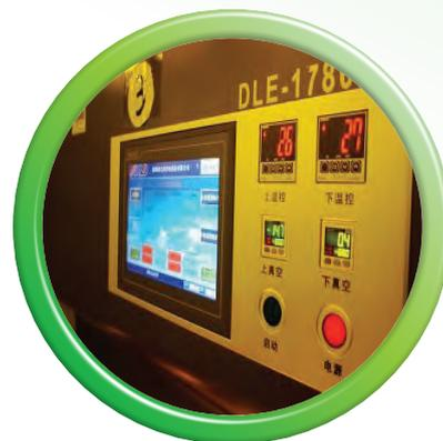
UV-LED線路板曝光系統的控制面板
