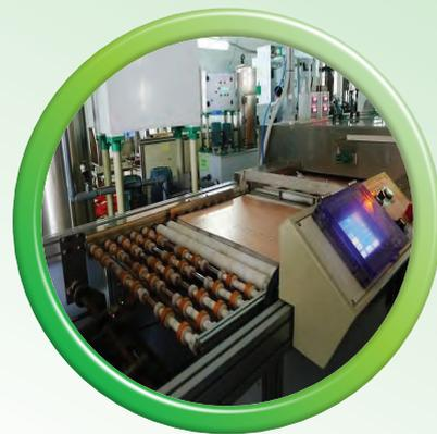
電路板以平放方式進行高分子導電膜加工
