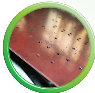
完成高分子導電膜的電路板
