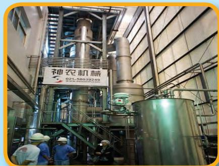
8噸蒸發量雙效降膜蒸發器的外觀
