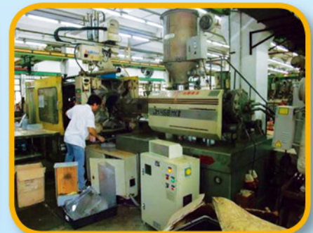
現場安裝了變頻器的注塑機
