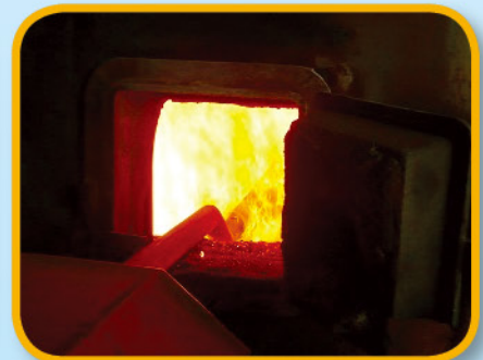
鏈條鍋爐撥火助燃系統的耐高溫撥火棒
