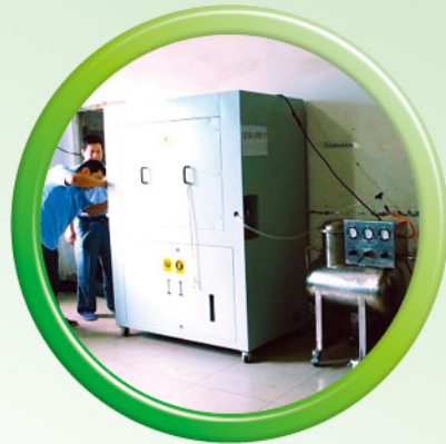
自動網板清洗機及防白水回收系統
