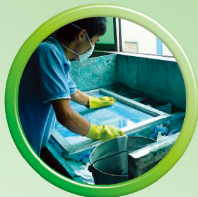
手動方式清洗絲網板
