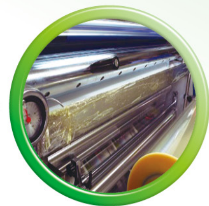
水性覆膜機使用的水性膠水
