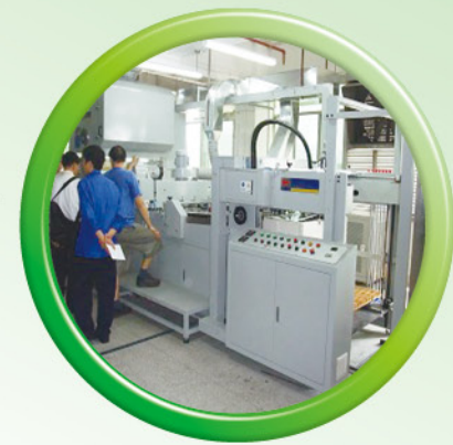
現場運行的水性覆膜機
