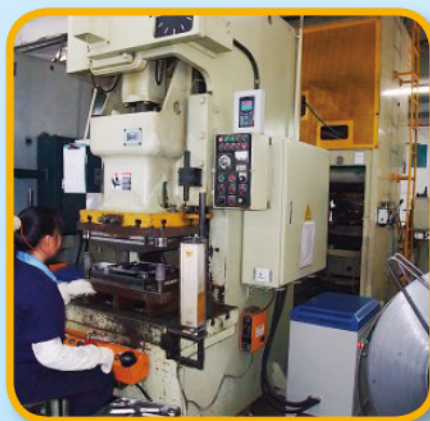
安裝了節電器的衝壓機
