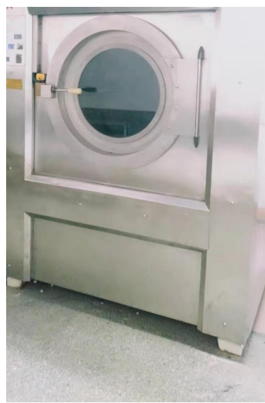
1#臭氧漂白設備
