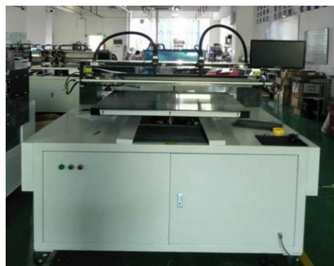
全自動切割機設備
