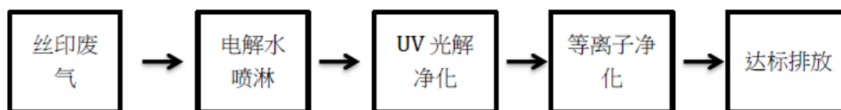
有機廢氣治理系統工藝流程圖
