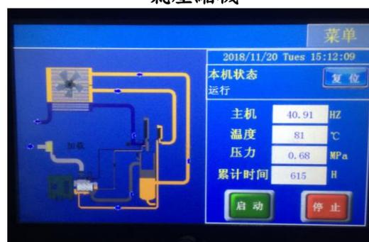
節能螺桿空氣壓縮機的操作介面
