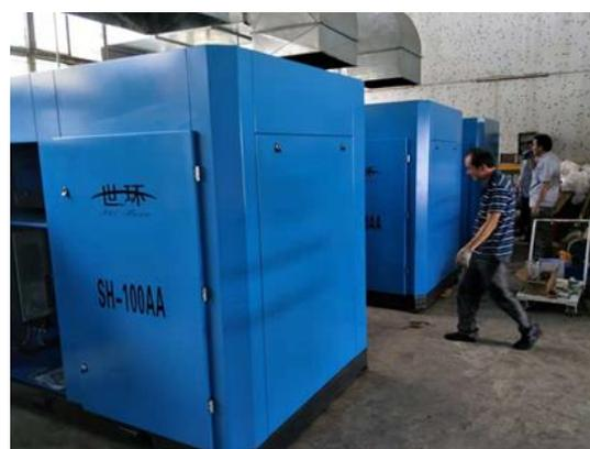
3台 75kW 永磁電機及變頻功能的節能螺桿空氣壓縮機
