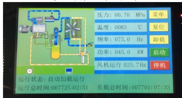
節能螺桿空氣壓縮機的操作介面
