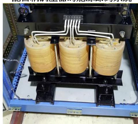
配自耦調壓器的能源節約系統
