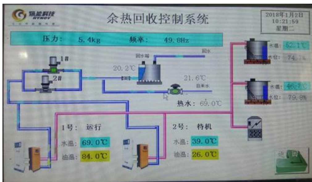
餘熱回收控制系統控制畫面
