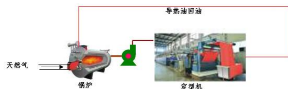
定型機導熱油供熱示意圖
