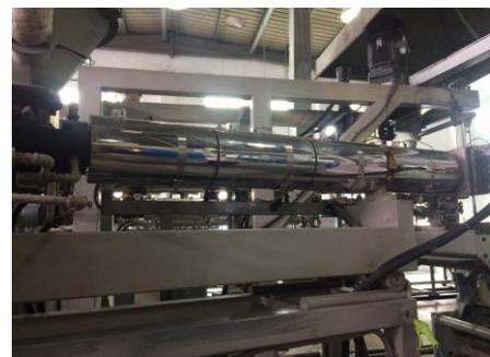
加裝了高效節能紅外線加熱系統的炮筒外觀
