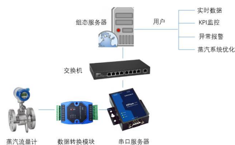
蒸汽管理系統架構
