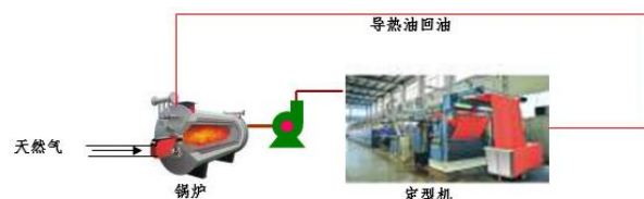
定型機導熱油供熱示意圖
