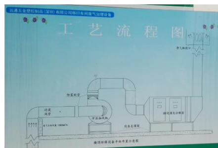
紫外線光催化氧化及活性炭吸附技術的組合式廢氣處理系統的工藝流程圖
