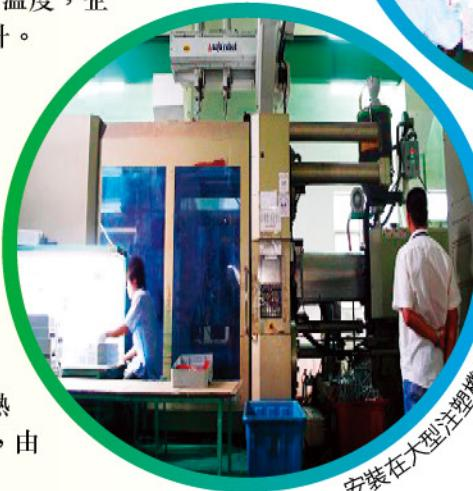
安裝在大型注塑機的熱源回收設備
