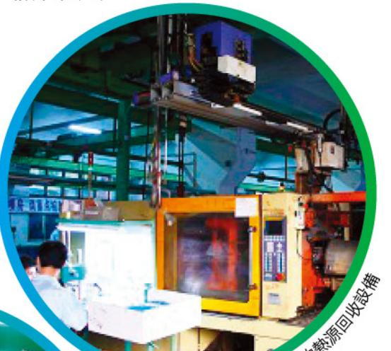
安裝在一般注塑機的熱源回收設備
