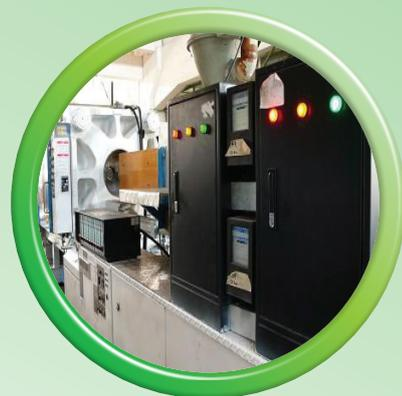
安裝在 550MG 注塑機的節能器
