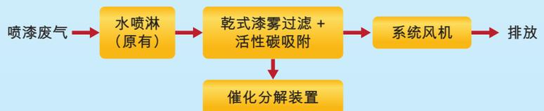
生产车间的有机废气由离心风机抽到车间外进入有机废气净化装置。废气首先通过漆雾筛检程式中的漆雾过滤层，去除漆雾粒子。漆雾净化后的气体再进入蜂窝形状的活性炭吸附床，与活性炭充分接触，利用活性炭对有机物质的强吸附性将气体净化，处理后的气体可达标排放，净化效率高达90-95%。由于吸附床经过一段时间的运行后会达到吸附饱和，此时开启脱附再生系统，利用热空气将活性炭内的有机废气脱附出来，通过控制脱附过程流量可将有机废气浓度浓缩10-20倍，脱附气流经催化床内设有电加热装置加热至300℃左右，在催化剂作用下起燃，分解成无害的二氧化碳和水分子并释放出大量热量，催化分解过程的净化效率可达97%以上，而释出的热量通过
