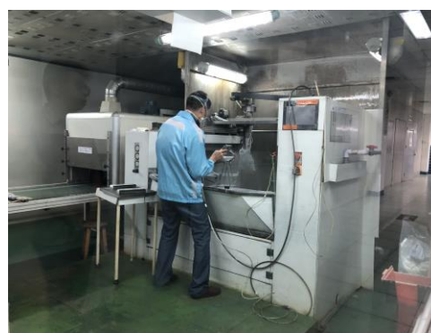
喷漆工序中的废气收集
