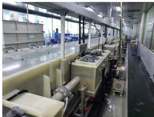
空压机热能回用于沉锡线的溶液加热
