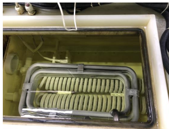
压机热能回用于溶液加热
