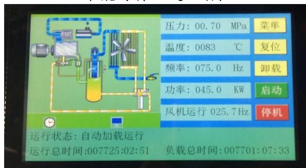
节能螺杆空气压缩机的操作介面
