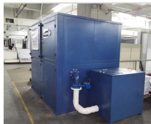
脉冲式布袋过滤装置 (入粉侧)
