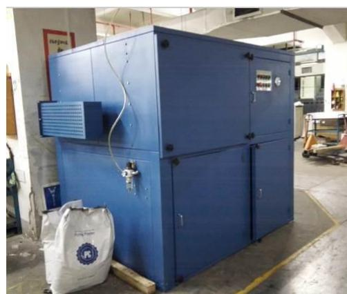
脉冲式布袋过滤装置 (入风侧)
