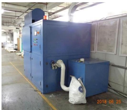
**脉冲式布袋过滤装置（入粉侧）**
