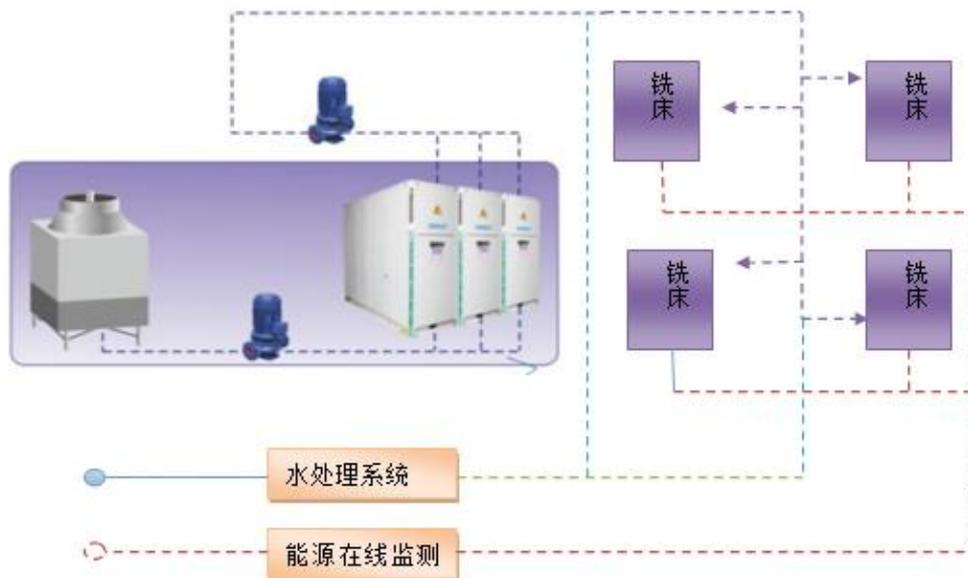
中央钻机冷却系统的工艺流程图
