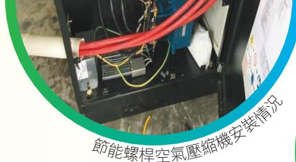
節能螺桿式空氣壓縮機的高效設計以稀土金屬做成永磁體的轉子，代替傳統轉子。這種設計顯著減少轉子的銅損或熱損耗及增加整體效率 10% 或以上。螺桿式空氣壓縮機的節能原理是當空壓機處於部分負載時，電機能隨氣量改變轉速，並仍保持高的效率；當空壓機滿負荷運行時，電機能高效運行；當空壓機不需要負載時，電機能無限制地停止運作，將能耗降為零，因此能大大減少不必要的能源浪費。此外，螺桿式空氣壓縮機配備的永磁電機亦有冷卻效果和運行可靠性較好的優點。
