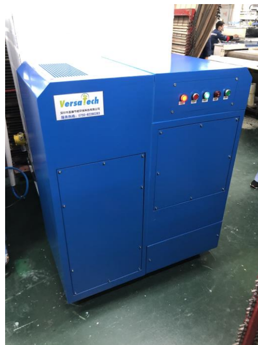
沸石吸附配合布袋過濾設備
