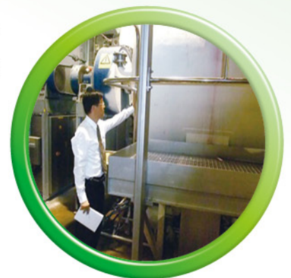
保溫塗層有效降低高溫染色機表面溫度
